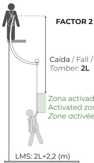
LMS= Longitud mínima de seguridad / Minimum safety lenght / Longueur minimale de sécurité
